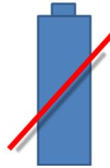
Bei den neueren Lithium-Batterien (inkl. Akkus) kann es bei einer mechanischen Beschädigung zu einem inneren Kurzschluss kommen. Durch eindringende Feuchtigkeit kann es zu chemischen Reaktionen, Hitzeentwicklung und Brandgefahr kommen. Diese wird durch die oft enthaltenen brennbaren Komponenten begünstigt.
